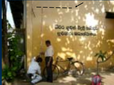
ゴール漁港における調査状況 (浸水高さの測定、矢印位置が浸水痕跡の上端)
