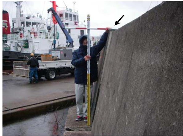
(4) 法線と直交する方向のずれ (約 0.05m)
