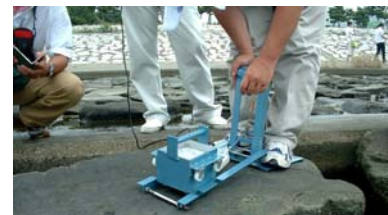
図-1 小野式携帯型滑り試験機(O-P・PSM)
