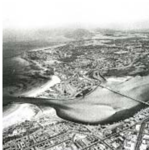
図 - 4 湾口部に設置された導流堤の例
