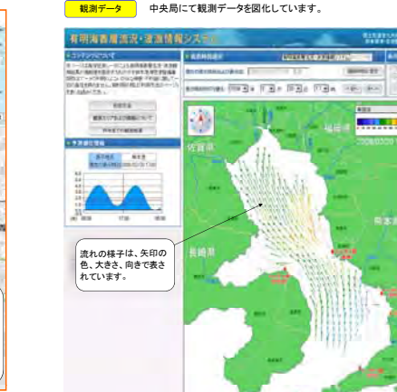
2局以上の観測局から扇状に発射されている電波が重なり合った範囲(電波照射範囲)※で、観測できます。(観測局=4局)
