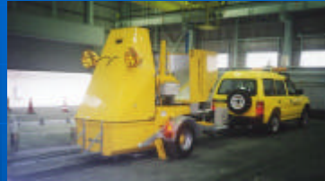
FWD载荷試験
