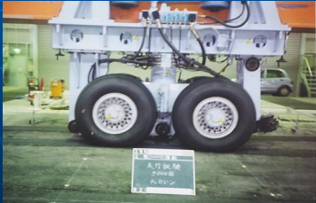
走行载荷試験
