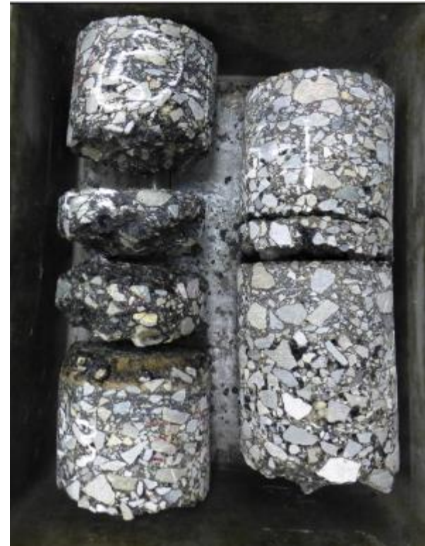
基層以深の 混合物はく離
