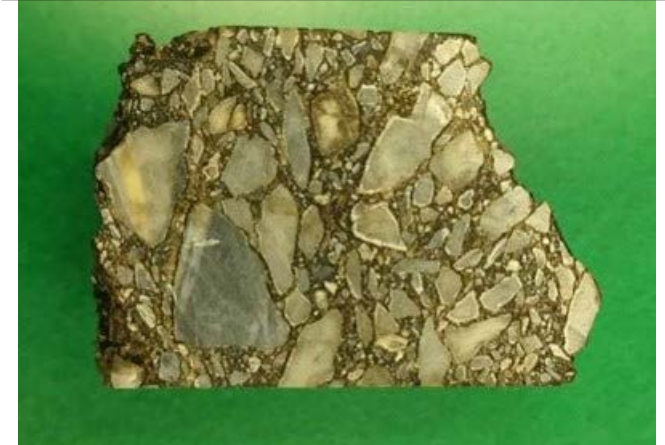
アスコンの切断面 (黒:アスファルト、黒以外:石)
