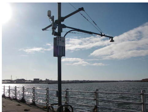
(1) 空中発射型超音波式潮位計
