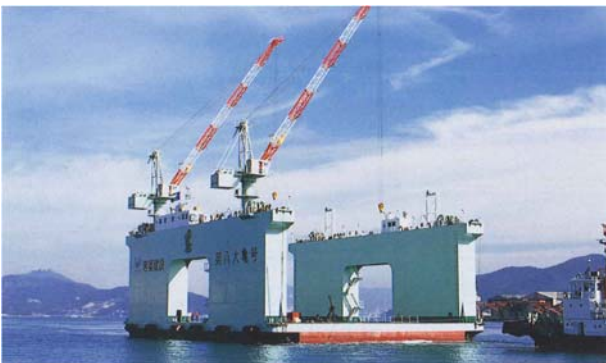
写真-A.11 ケーソン製作用作業台船 2)
