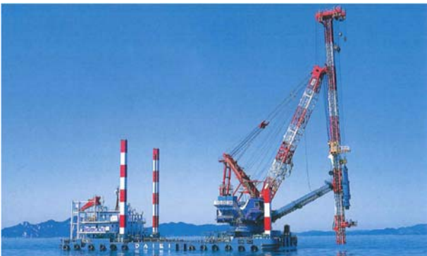
写真-A.12 杭打船 2)
