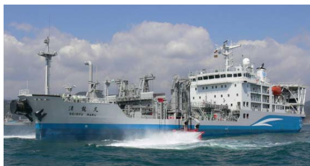
写真-4.1 浚渫兼油回収船清龍丸の全景
