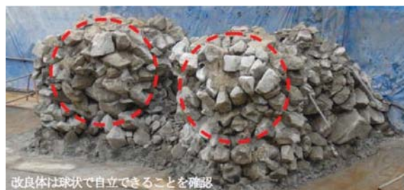
写真-2.1 改良体の出来形 3)
