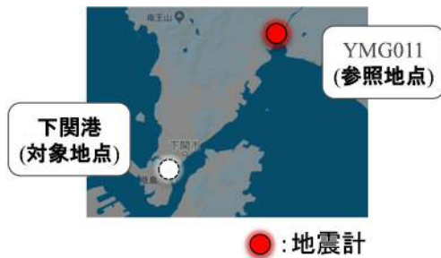
図-34 地震計の設置位置 (常時微動観測に基づく評価の場合)
