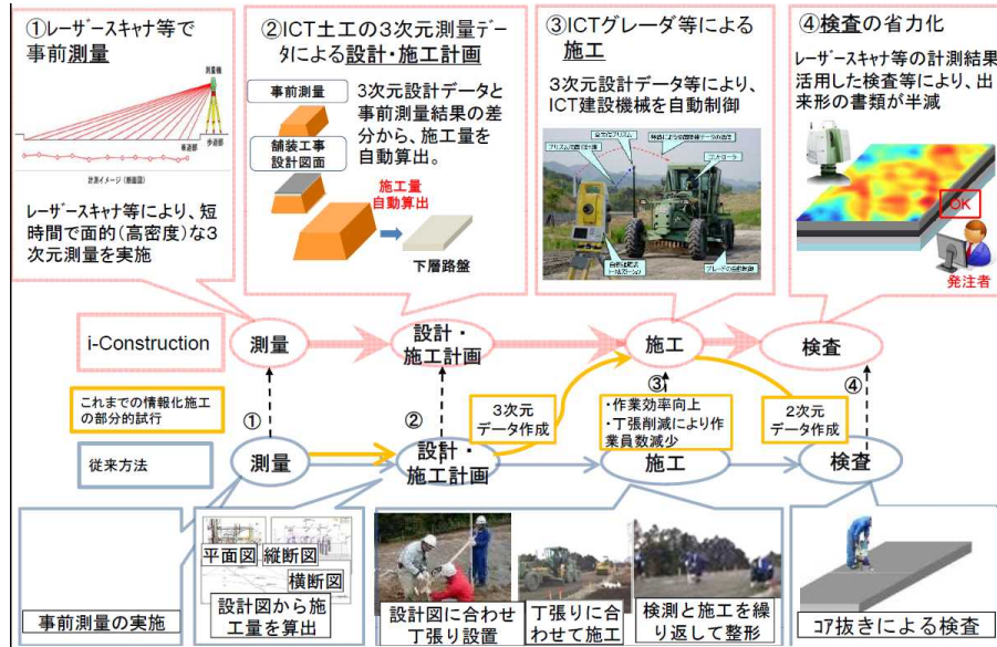
図-2.2 ICT舗装工の概念 8)
