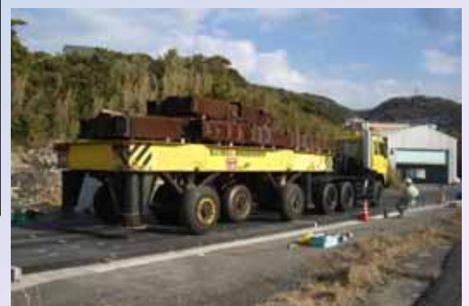
新しい空港舗装材料の耐久性評価試験
