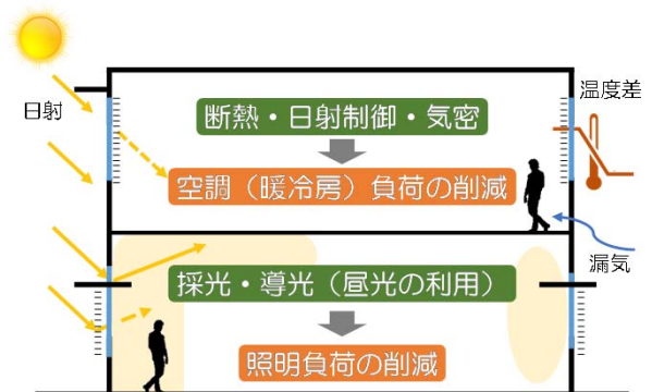
ファサードによる負荷削減の例
