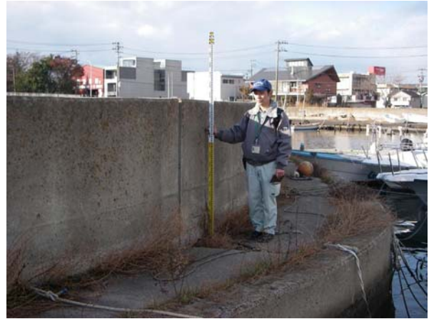
(3) 堤体間の目開き（最大 6 cm, 陸側からみた状況） (4) 胸壁の天端高さの測定
