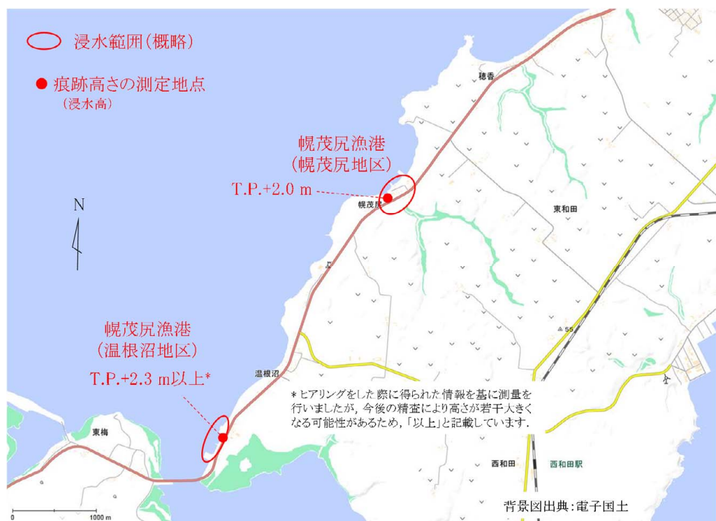
図－4 浸水が発生した地区と痕跡高さ（根室市西部）
