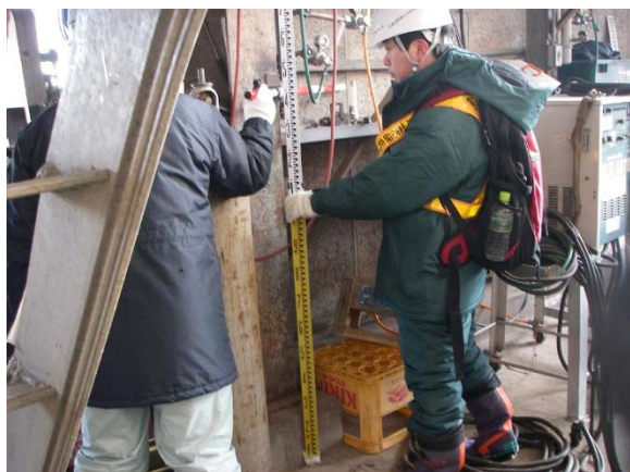
写真－１ 造船所建屋内の浸水高さの測定 (穂香地区)
