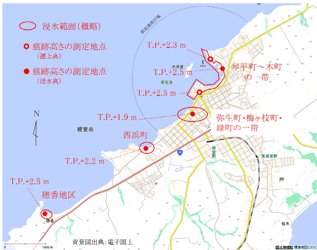
図－3 浸水が発生した地区と痕跡高さ（根室市中心部）
