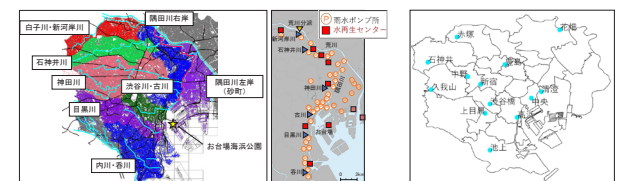
図1 CSO量計算に用いた河川排水区と下水施設配置 図2 予測に用いた降雨観測13地点
