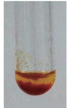
図2 アルカリ雰囲気中で沈殿した硝酸鉄
