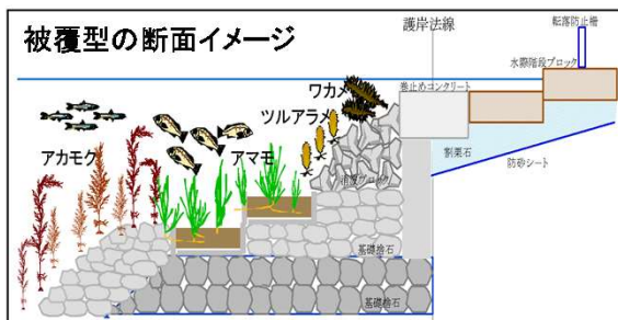
生物共生型港湾構造物の設置事例
