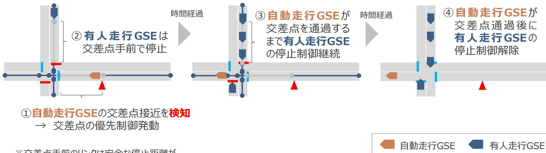
※交差点手前のリンクは安全な停止距離が確保可能な距離として15～20m程度で設定
