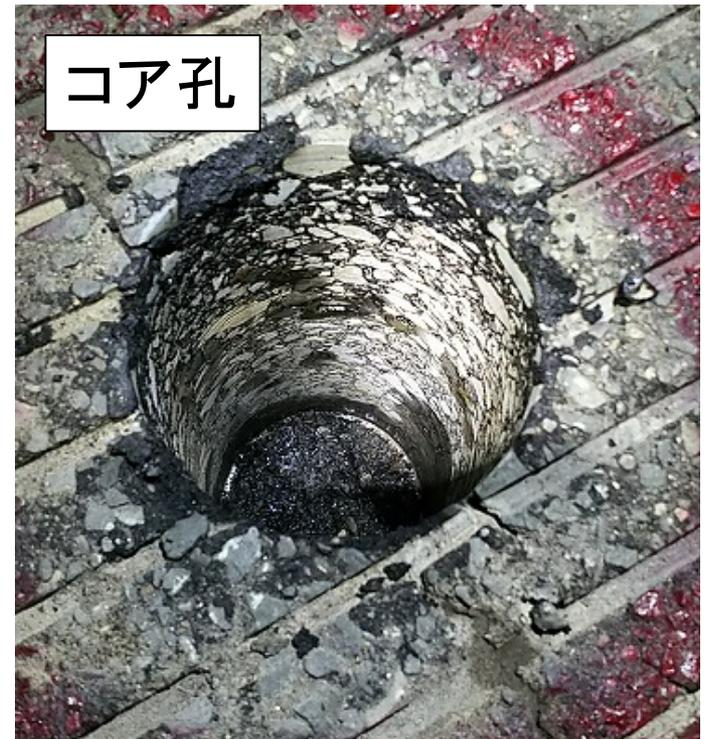
**目的:** 水の浸透状況を間隙水圧計で調べること
