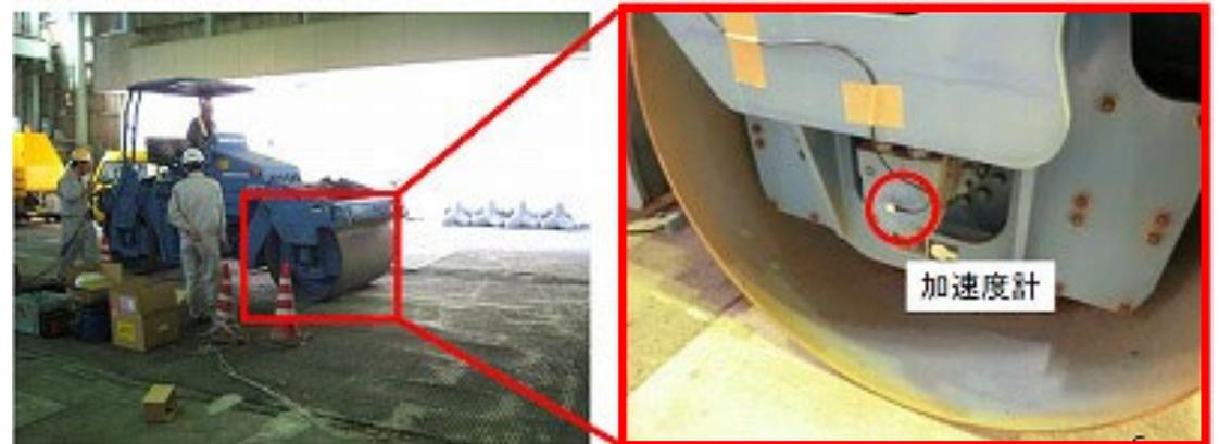
試験舗装での鉛直加速度データ
