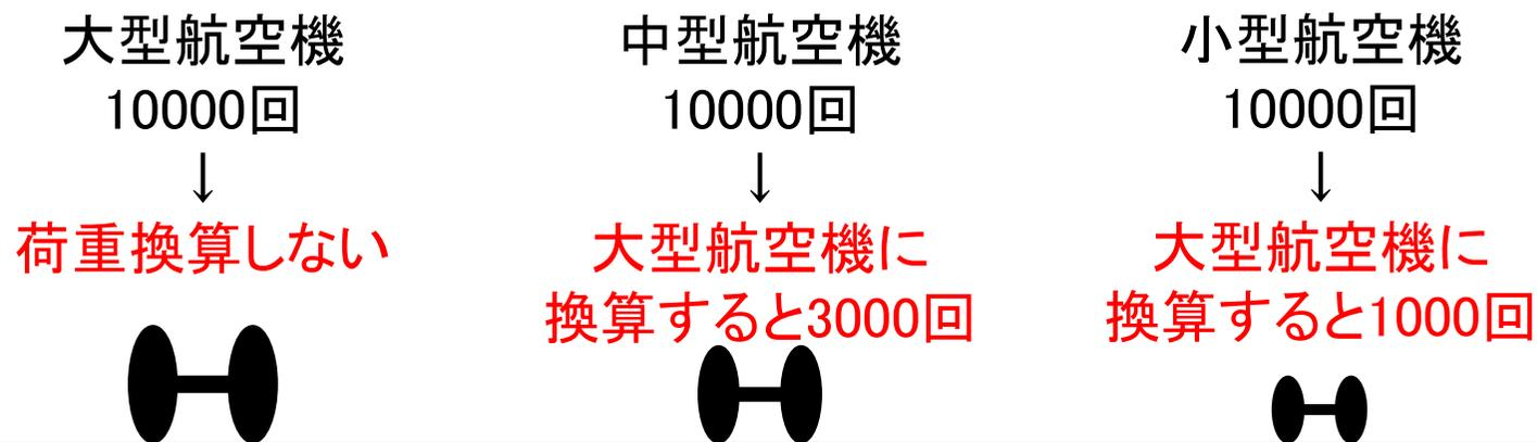
$$\sqrt{\text{設計荷重} \cdot \log_{10}(\text{設計交通量})} = \text{一定}$$
