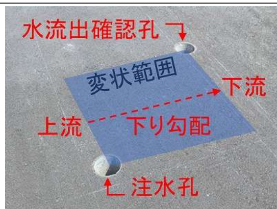
舗装完成後に注水孔の設置
