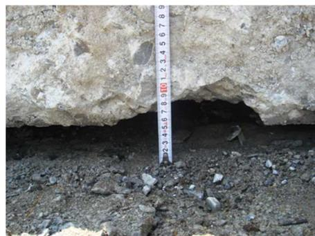
写真-3.1 K9 のコンクリート版下の空洞
