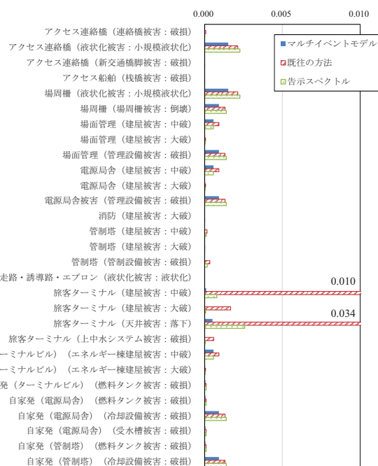
図-21 レベル 1 地震動による構成要素の被害レベルの 損傷確率の比較
