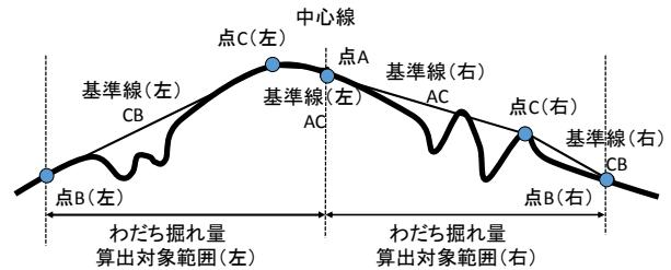
図-5 わだち掘れ量の算出手順2(逐次法)
