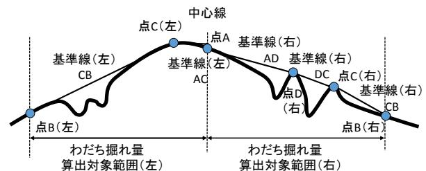
図-6 わだち掘れ量の算出手順3(逐次法)
