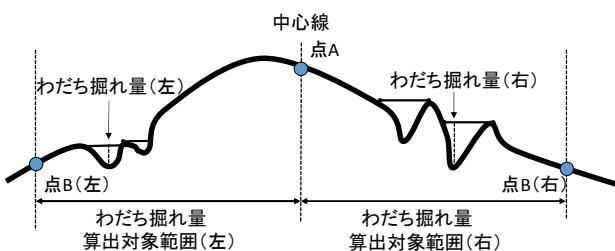
図-8 わだち掘れ量の算出手順（水深法）
