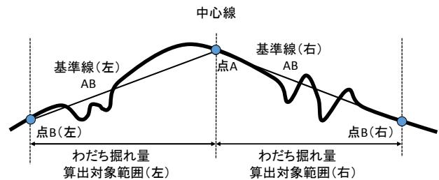
図-4 わだち掘れ量の算出手順1(逐次法)
