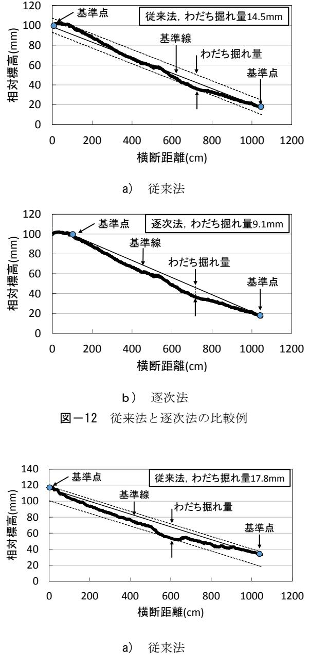
図-12 従来法と逐次法の比較例
