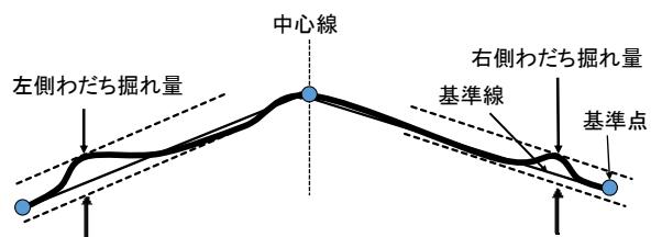
図-2 わだち掘れ量を正確に算出できない例1
