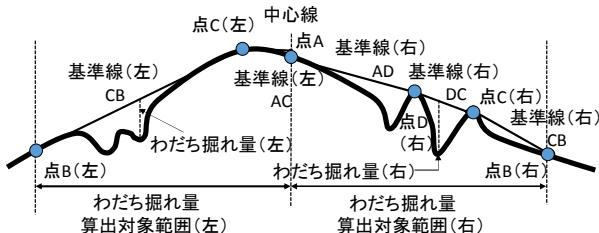
図-7 わだち掘れ量の算出手順4（逐次法）
