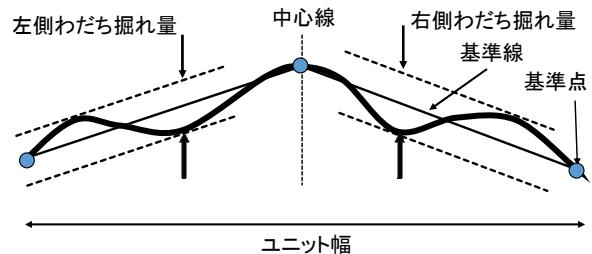
図-1 わだち掘れ量の定義（従来法）
