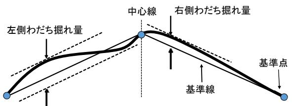
図-3 わだち掘れ量を正確に算出できない例2
