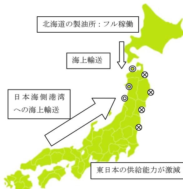
図4.1 東日本大震災後の石油の代替輸送例<sup>10)</sup>
