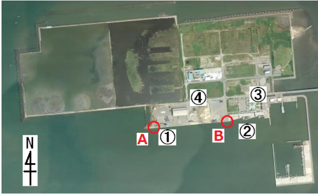
図-4.1 熊本港における調査位置（国土地理院のデータをもとに作成）。①は岸壁（-7.5m）、②はフェリーターミナル、③は液状化による段差が見られた箇所、④は液状化による噴砂の跡が見られた箇所。A、B は地震による残留水平変位の測量結果が得られている箇所（本文参照）。
