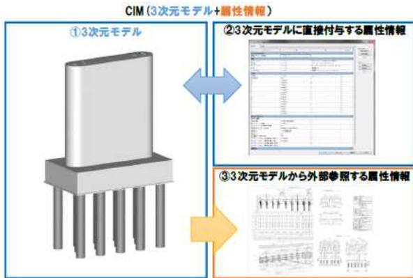
図-2.5 構造物のCIMモデル<sup>6)</sup>
