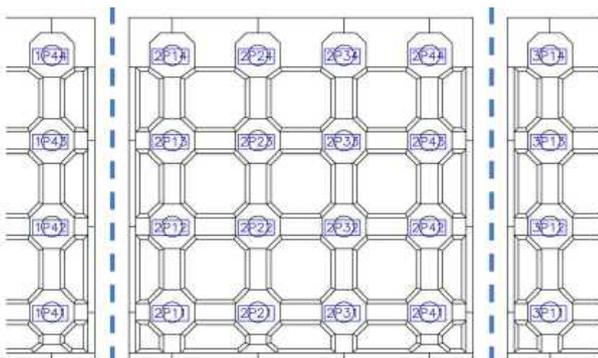
図-B.9 座標系の設定例（鋼杭等）<sup>14)</sup>
