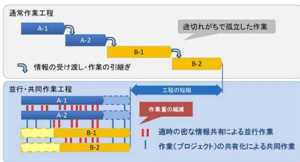
図-2.3 コンカレントエンジニアリングのイメージ<sup>6)</sup>
