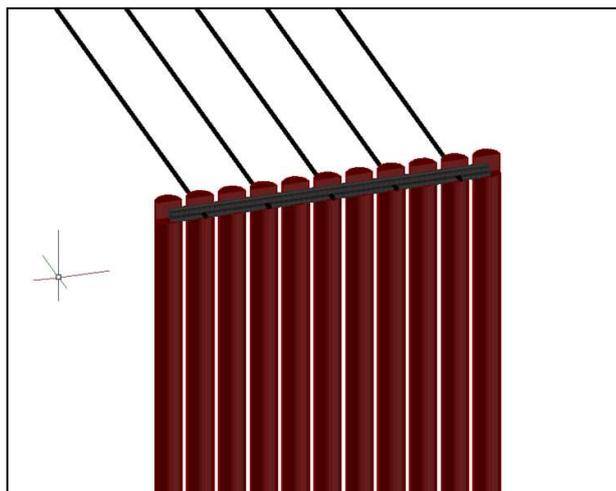
図-3.13 本体工（鋼管矢板）のモデル事例（清水岸壁）
