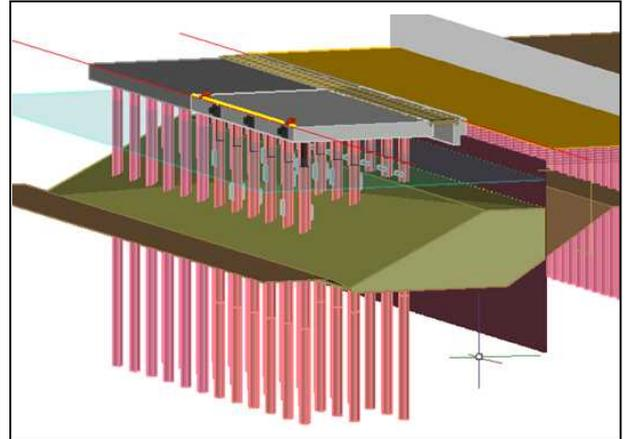
図-B.2 直杭式棧橋の3次元モデル
