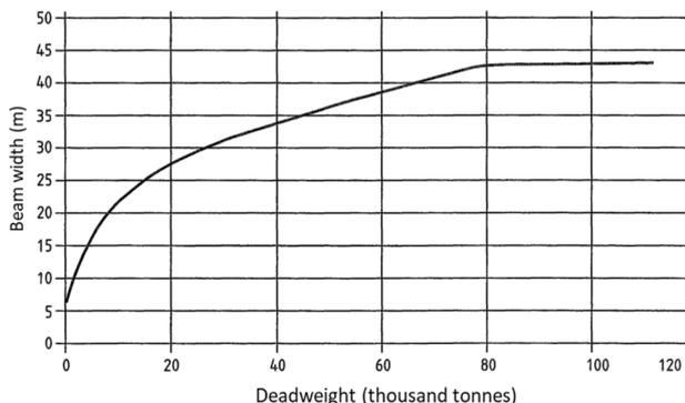
図-2.3 標準的な船舶の標準寸法<sup>24)</sup>
