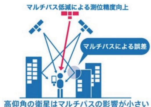
図 5-1 マルチパスによる測位精度低下 6)
