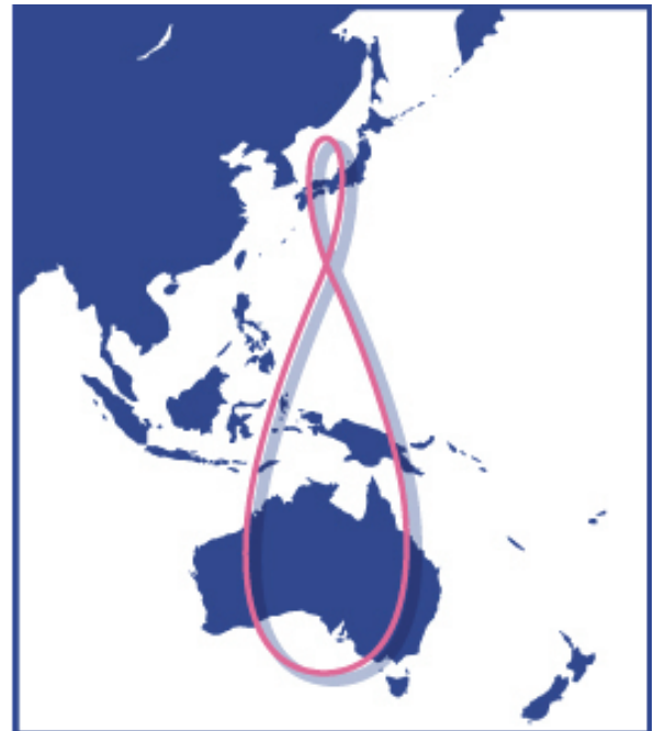
図 4-2 地表面に投射したみちびきの軌道 5)
