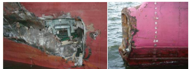
(a)船側部の破口
