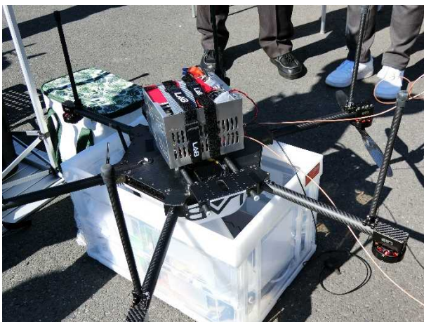
写真-5.3 電波伝搬測定用機材（伝搬測定装置）
