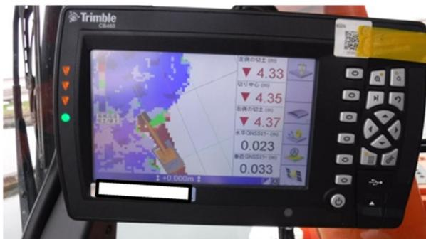
図-4.6 バックホウ搭載 ICT 機器
