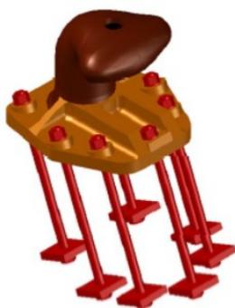
図-1.1 係船柱（曲柱）に関する全体構造（例）
