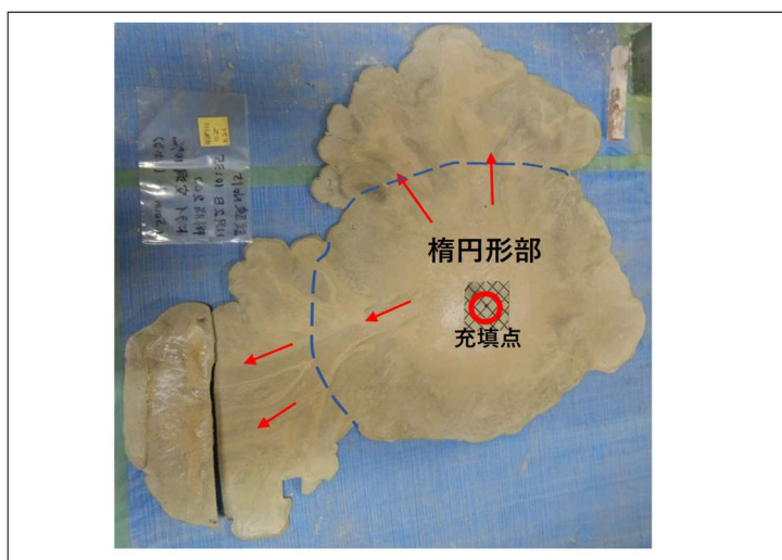
図-4.5 水平空洞における形成樹脂の下面（No.1，樹脂 200，赤矢印方向の白い筋は樹脂の流動痕）
