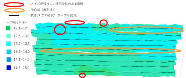
図-3.15 地形段彩図(荻田港:スワ幅90° ラップ率20%)
