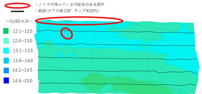
図-3.17 地形段彩図(荻田港:スワ幅130° ラップ率20%)
