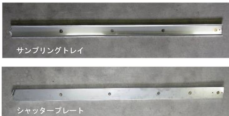
図-B. 3 ジオスライサーのサンプリングトレイおよびシャッタープレート（高田ら 2002 を参考に作成）
