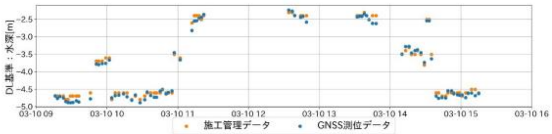
図-74 バケット深度の計測結果（GNSS測位は1分平均値，2025年3月10日）
