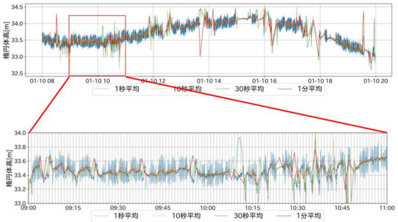
図-85 クレーン旋回中心部の楕円体高の計測結果（2025年1月10日）
