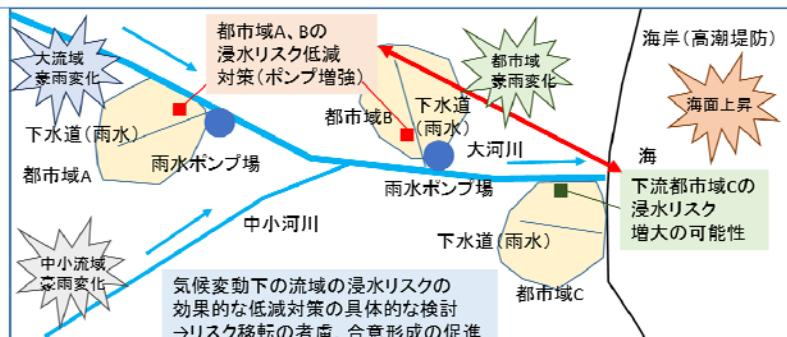
【図1 統合的浸水リスク評価概念図】
