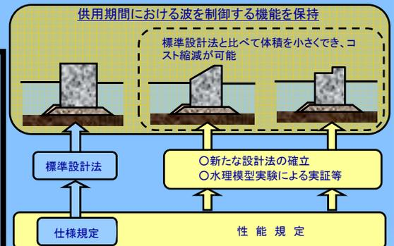
仕様基準と性能基準による設計の違い（防波堤の場合）
