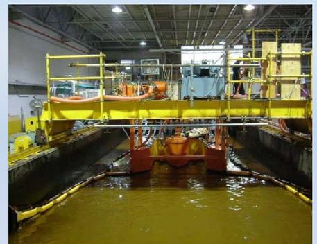
新型油回収装置の性能試験
