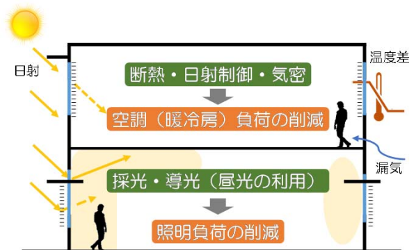
ファサードによる負荷削減の例
