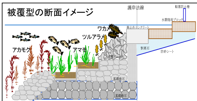
生物共生型港湾構造物の設置事例
