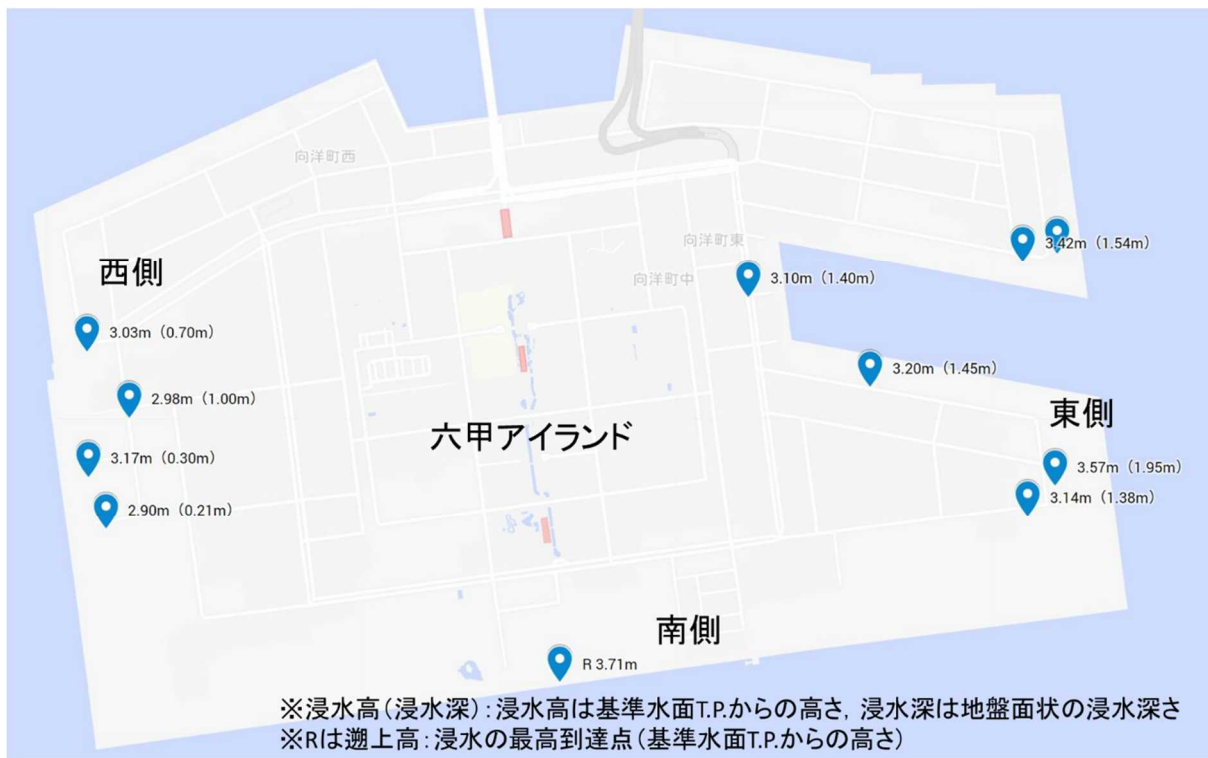
図2 六甲アイランドの浸水高(浸水深)
