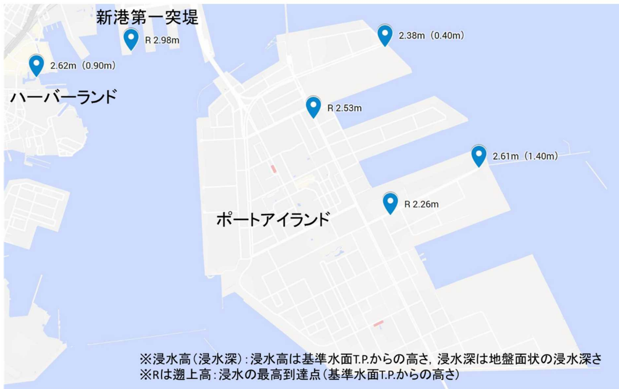
図3 ポートアイランドの浸水高(浸水深)
