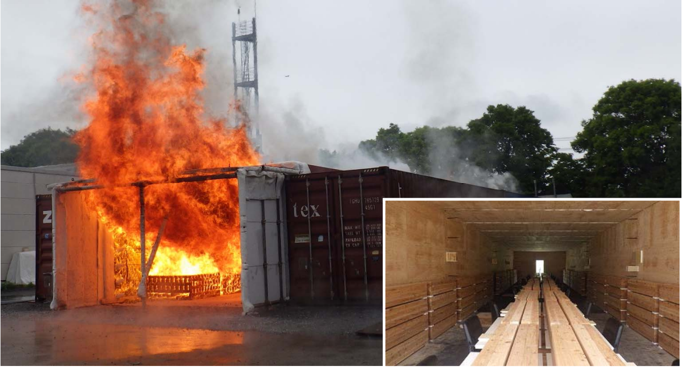
※火災性状や消火活動の効果等を実験的に把握するための木造の実大規模の区画火災を再現
