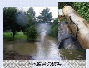
下水道管の破損による道路の陥没
