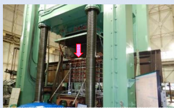
鋼I桁供試体
