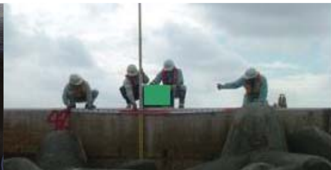
消波工の点検状況(沈下量測定)
