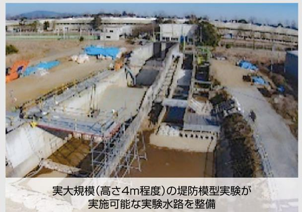
実大規模(高さ4m程度)の堤防模型実験が実施可能な実験水路を整備
